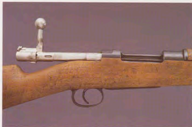
Tras el disparo, en la maniobra de retroceso, mediante sendos movimientos de rotación y traslación, el cerrojo abre la recámara, expulsa el cartucho vacío y permite la entrada en el cañón del primer cartucho del depósito.
