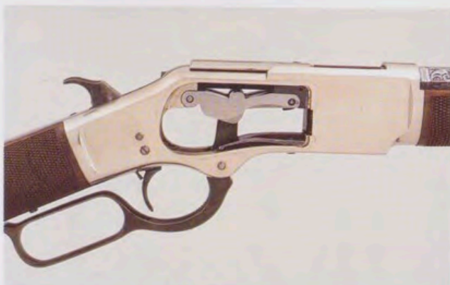
Con la palanca hacia arriba. Mientras la teja descende, avanza el bloque percutor. El arma está en disposición de hacer fuego. Impulsados por el muelle de transporte, los cartuchos, en hilera dentro del depósito tubular, se irán presentando e introduciendo sucesivamente en la teja elevadora.
