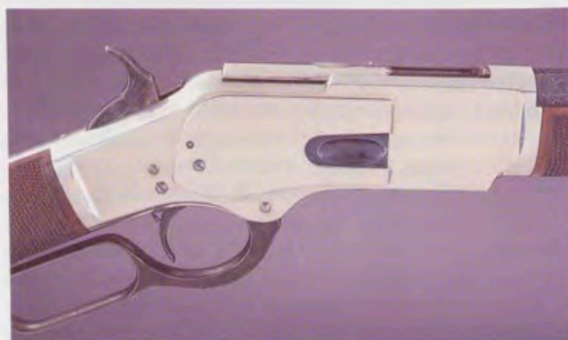
Ventana de recepción. Esta portezuela permite introducir la munición en el depósito tubular y caracteriza a todos los modelos de Winchester.
