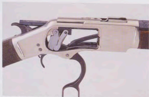
Con la palanca hacia abajo. Esta acción lleva hacia atrás el bloque de cierre, elevándose la teja o transportador que, mientras expulsa una vaina vacía, dirige un nuevo cartucho hacia la recámara.
