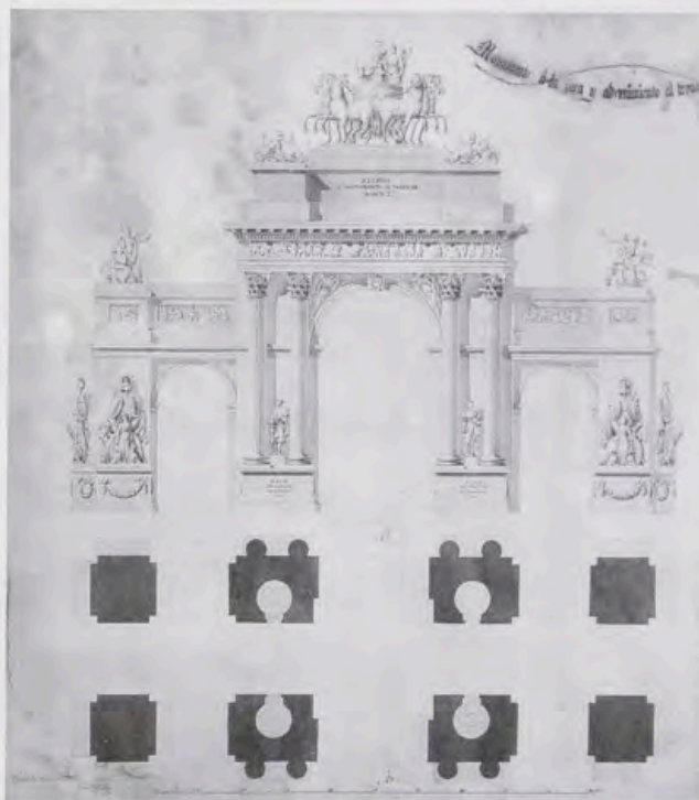
Proyecto de Arco de Triunfo de Francisco Valles, junio 1834. Planta y alzado.
