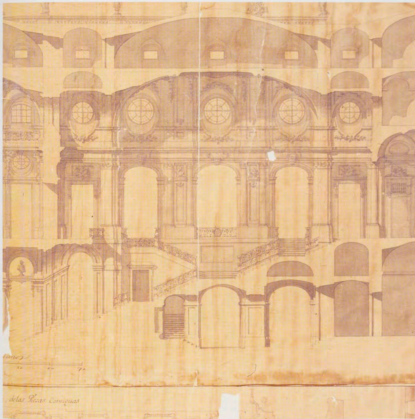
G.B. Sacchetti: proyecto definitivo para las escaleras principales, concebido en 1745 y aprobado en 1747. A.G.P. 74. Detalle con la sección longitudinal de la escalera de mano derecha.
