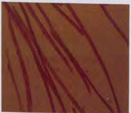
Observación al microscopio de un corte longitudinal de varios filamentos con identificación del material de seda.
