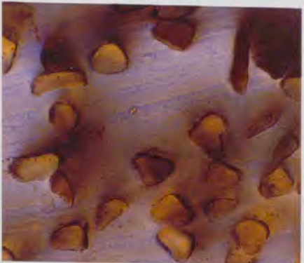
Observación al microscopio de un corte transversal de varios filamentos con identificación del material de seda.
