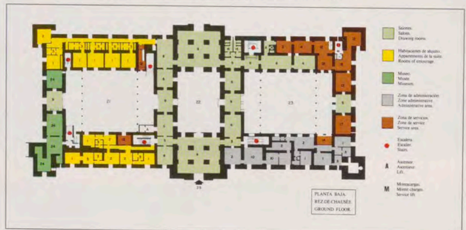
Planos de la planta baja. El primero es típico de obra, y el otro es el esquema coloreado para la fácil comprensión de circulaciones y distribución de zonas.
