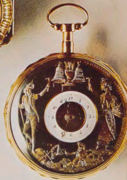
Pieza de Breguet, termina hacia 1785. Este tipo de reloj se llamó Martin Martine por la pareja en miniatura que toca las campanas cada cuar de hora.
