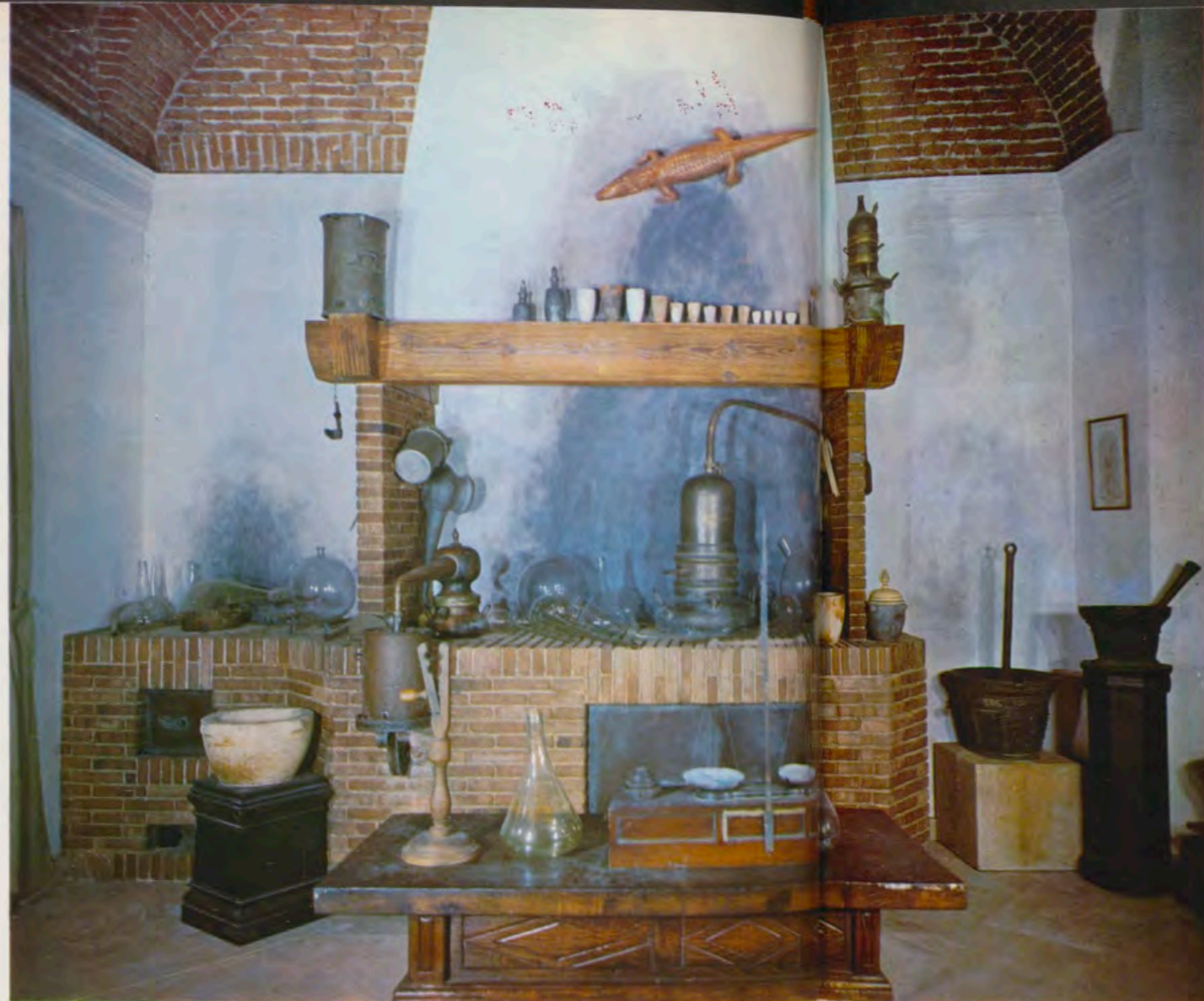
Uno de los hornos de la sala de destilaciones, con alambiques, morteros de bronce y de piedra, retortas y barro refractario.
